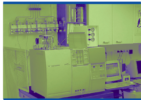
Analizador elemental para la determinación de nitrógeno total © M.D. Curt
