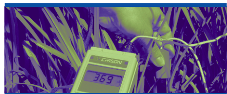
Lectura de la conductividad eléctrica en un humedal con Sparganium spp.
