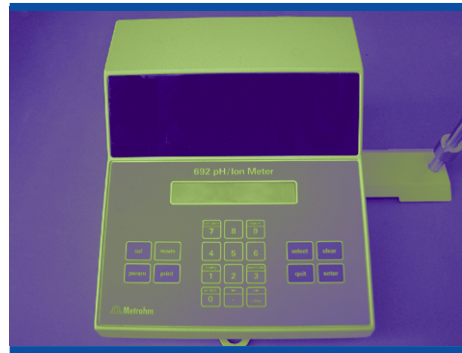
Ionómetro para el registro de las lecturas de electrodos selectivos © M.D. Curt
